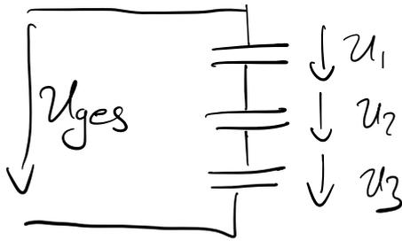
Spannung verteilt sich über alle Kondensatoren
